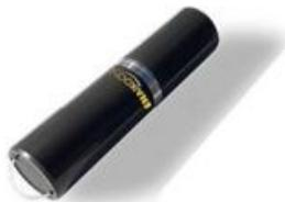
Das **mobile GPS Ortungsmodul** benötigt keine Bordspannung und hat ein stabförmiges Metallgehäuse, mit integrierter Antenne und einer Lithium-Batterie als Spannungsquelle. Durch die robuste Bauform kann das Ortungsmodul ganz einfach an verschiedenen Stellen im Boot platziert werden. Es sendet zu einer bestimmten Uhrzeit oder in einem voreingestellten Zeitintervall jeweils eine Positionsmeldung.
